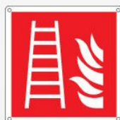
Scala antincendio F003 ●
